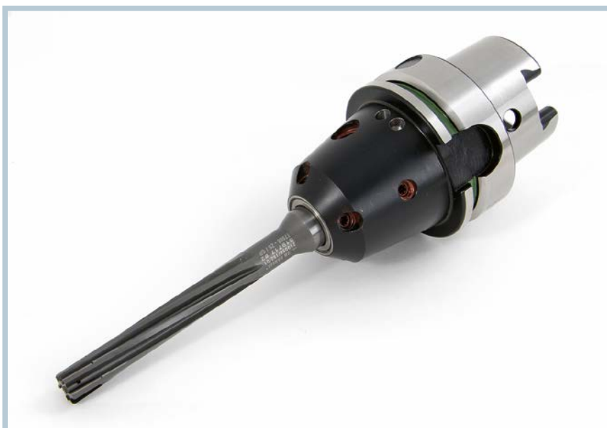
3 3- bis 7-schneidiges Reibwerkzeug im Helix-Design mit VHM-Grundkörper, das die Zykluszeit um 50 Prozent verkürzt und die Standzeit in ähnlicher Größenordnung verlängert (©
